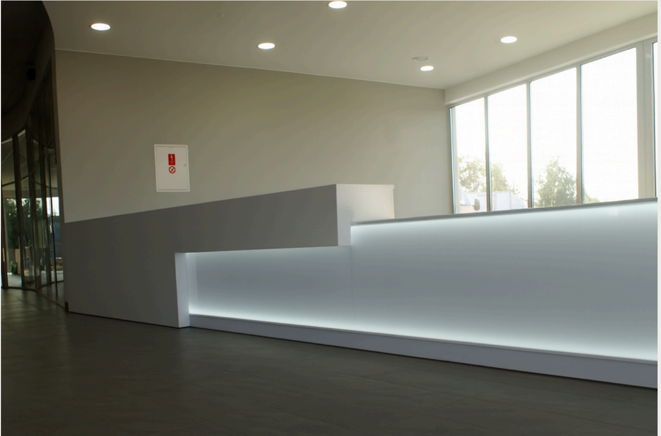
MONOLITYCZNA LADA RECEPCYJNA WYKONANA Z KOMPOZYTU POŁĄCZONEGO Z PODŚWIETLONĄ PLEXI, BUDYNEK BIBLIOTEKI
